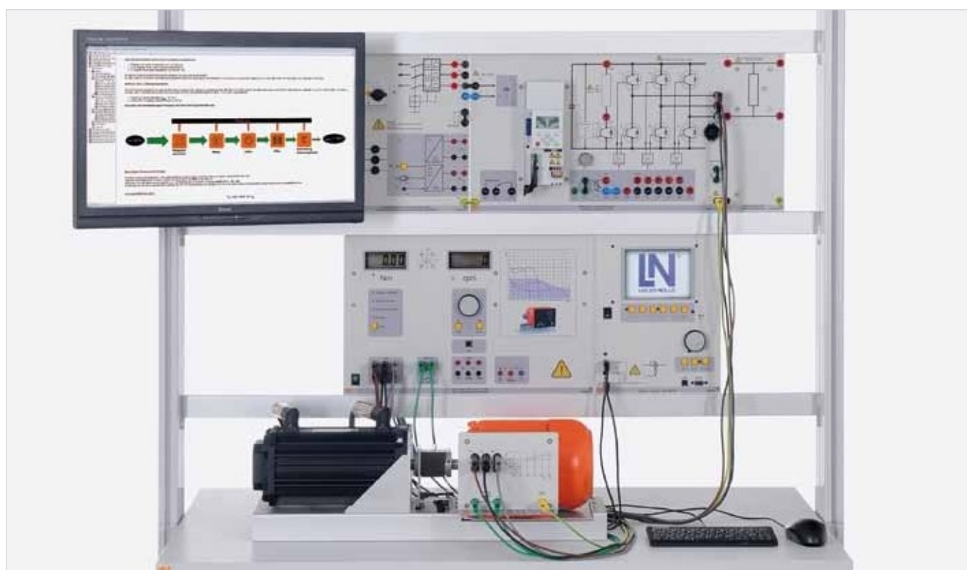
Zariadenie „Energeticky efektívne pohony s frekvenčnými meničmi“ obsahuje vysokoefektívny motor, frekvenčný menič a servobrzdú
