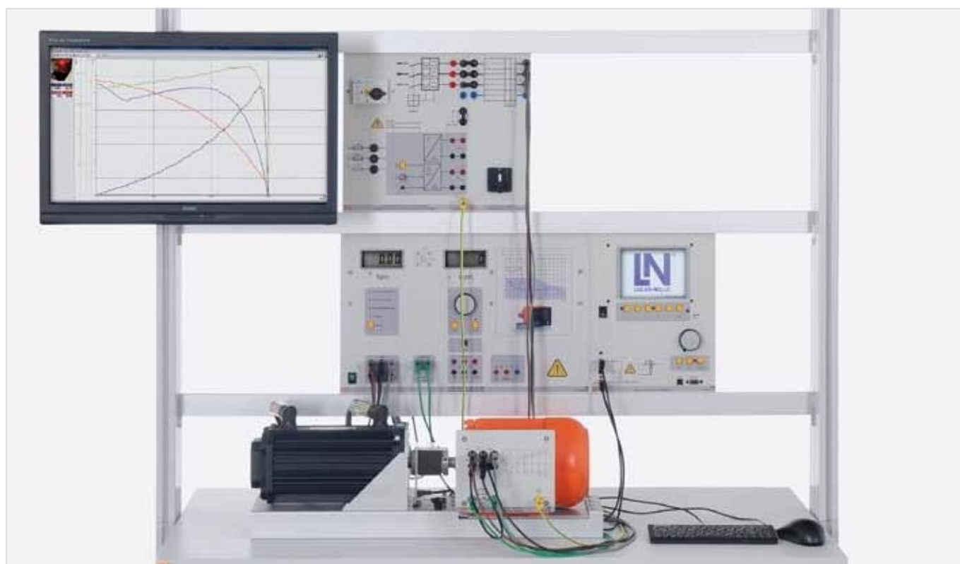
Zariadenie „Energeticky úsporný motor“ obsahuje vysokoefektívny motor a servobrzdú.
