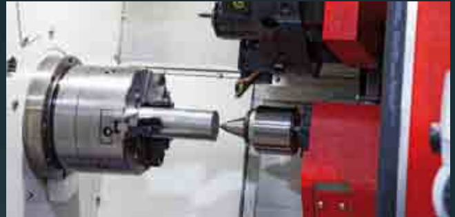
Programmierbarer, hydraulischer Reitstock
